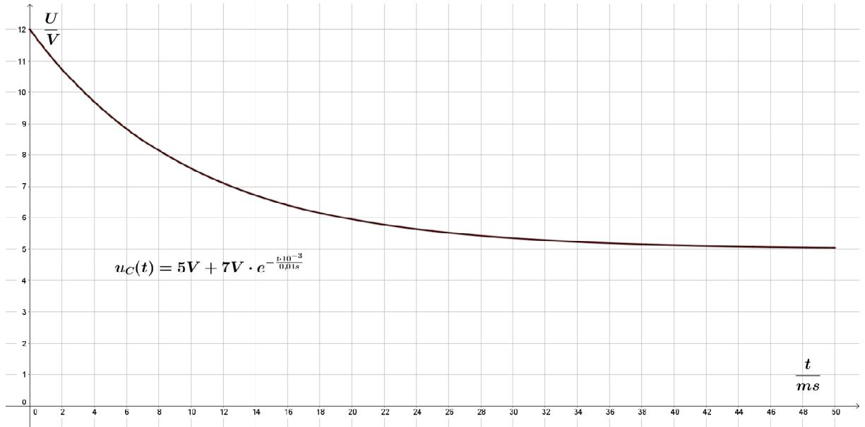
Nehmen wir an der Kondensator soll auf einen Wert von  $5 V$  entladen werden. Dann genügt es die Entladefunktion leicht zu modifizieren.
